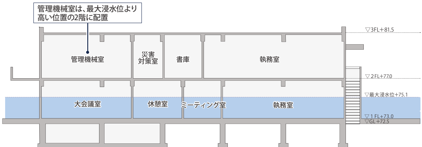
図4 新管理棟の浸水対策イメージ
