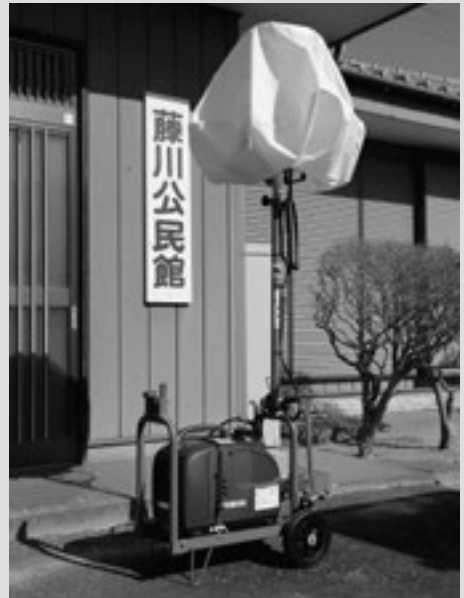
藤川公民館に整備されたバルーン照明機
